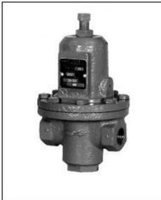
La Serie 98 es usada para aplicaciones de contrapresión o alivio en servicios de líquido, gas, aire, vapor. Los Tipos 98L, 98H y 98HH son de acción-directa y resorte-cargado. Los Tipos 98LD y 98HD utilizan presión adicional de carga para mantener presiones diferenciales de alivio, contrapresiones o para ajuste puntual remoto.
